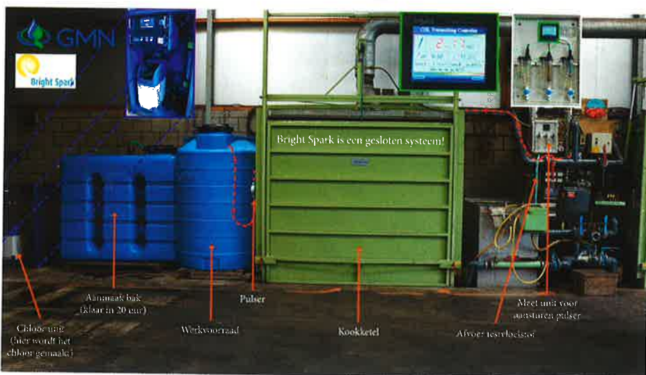
In het Bright Spark/Akerboom/GMN-systeem wordt het chloorniveau automatisch op peil gehouden. De lucht rondom het systeem wordt afgezogen, zodat het personeel niet blootgesteld wordt aan eventuele chloordampen
